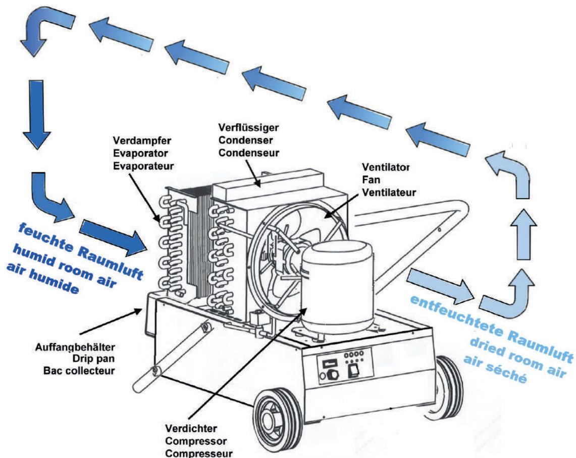
dépend de la dimension de la pièce à déshumidifier, du degré relatif d'humidité de l'air et de sa température. L'appareil s'enclenche en tournant le bouton de réglage sur la position médiane.
