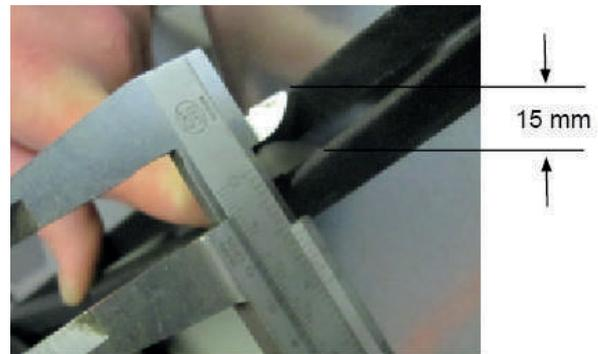
La tension du courroie trapézoïdale est bonne, si sous une faible pression sur la partie avant du courroie trapézoïdale, une mesure de 15 mm peut être maintenu.
