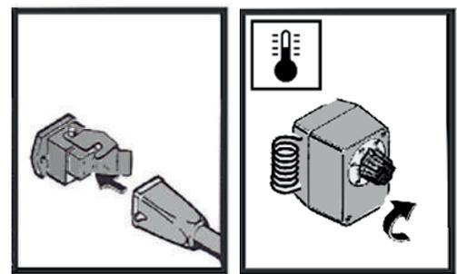
Die Steuerung der Heizzentrale und des Brenners erfolgt über den Wahlschalter
