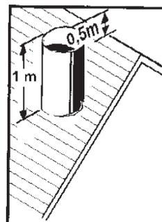
La sortie de la cheminée ne doit pas être placée à proximité immédiate d'une fenêtre ou d'un balcon.
