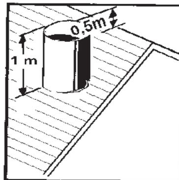
Die Mündung des Abgasrohres darf nicht in unmittelbarer Nähe von einem Fenster oder Balkon liegen.
