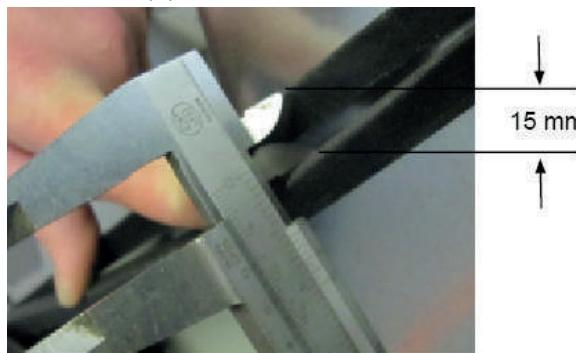
Keilriemenspannung ist in Ordnung, wenn durch geringen Druck auf den vorderen Keilriemen ein maximales Maß von 15 mm eingehalten werden kann.
