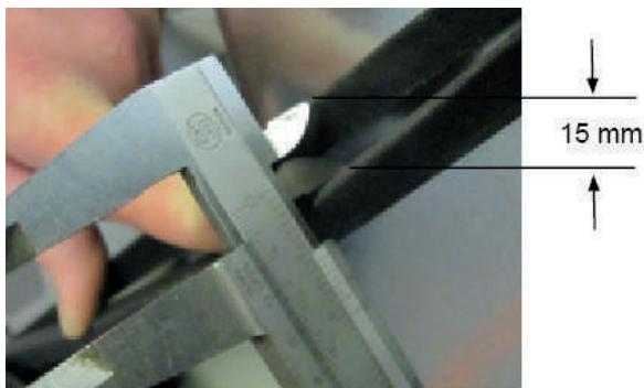
La tension du courroie trapézoïdale est bonne, si sous une faible pression sur la partie avant du courroie trapézoïdale, une meture de 15 mm peut être maintenu.
